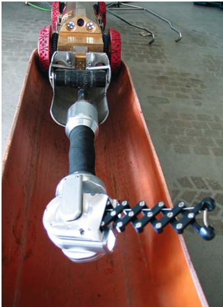
MINIATURISIERTE LINDAUER SCHERE: Bild 5 für Leitungsnetze ab DN 100, mit Spülantrieb lieferbar, bietet optional das System ASYS zur exakten Einmessung des Leitungsverlaufs
