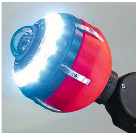
DIGITALKAMERA NEMO: Bild 1 mit dieser Kamera will auch die Fa. Rausch, Weißensberg, künftig im Grundleitungsnetz abbiegen.
