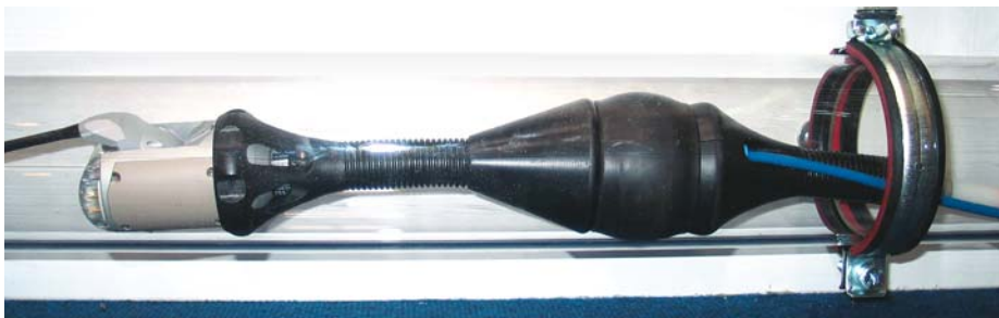
KAMERA ORION L VON IBAK KIEL: abbiegefähiges Gerät, mit Spülunterstützung und in Kombination mit einer Absperrblase auf der IFAT vorgestellt Bild 4
